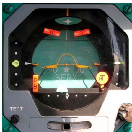
Рис. 4. Авиагоризонты ПКП-77 (слева) и АГР-74 (справа)
