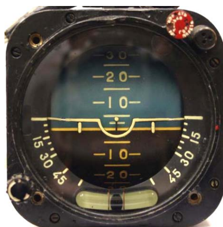
Рис. 3. Авиагоризонты АГД-1 (слева) и АГР-81 (справа)
