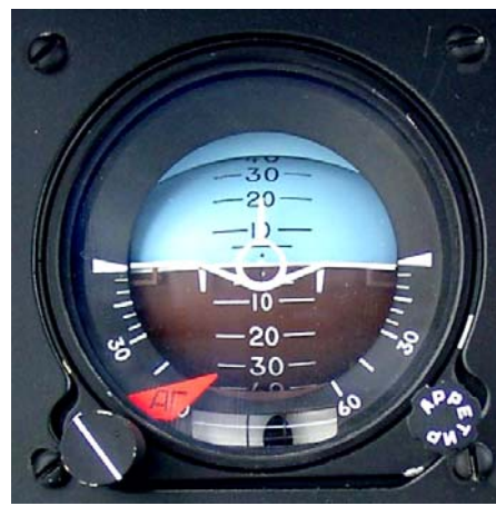
Рис. 3. Авиагоризонты АГД-1 (слева) и АГР-81 (справа)
