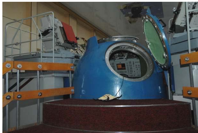
Тренажер сближения «Дон-Союз» (справа и слева видно оборудование оптической системы на иллюминаторах) (с официального сайта ЦПК им. Ю.А. Гагарина http://www.gctc.ru/main.php?id=801 )
