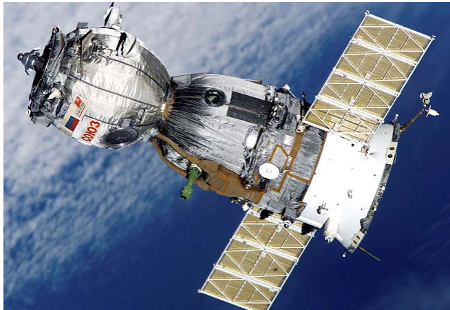
Космический корабль «Союз-ТМА» (снизу хорошо видна внешняя часть ВСК зеленого цвета) ( http://commons.wikimedia.org/wiki/File:Soyuz_TMA-7_spacecraft2edit1.jpg?uselang=ru )
